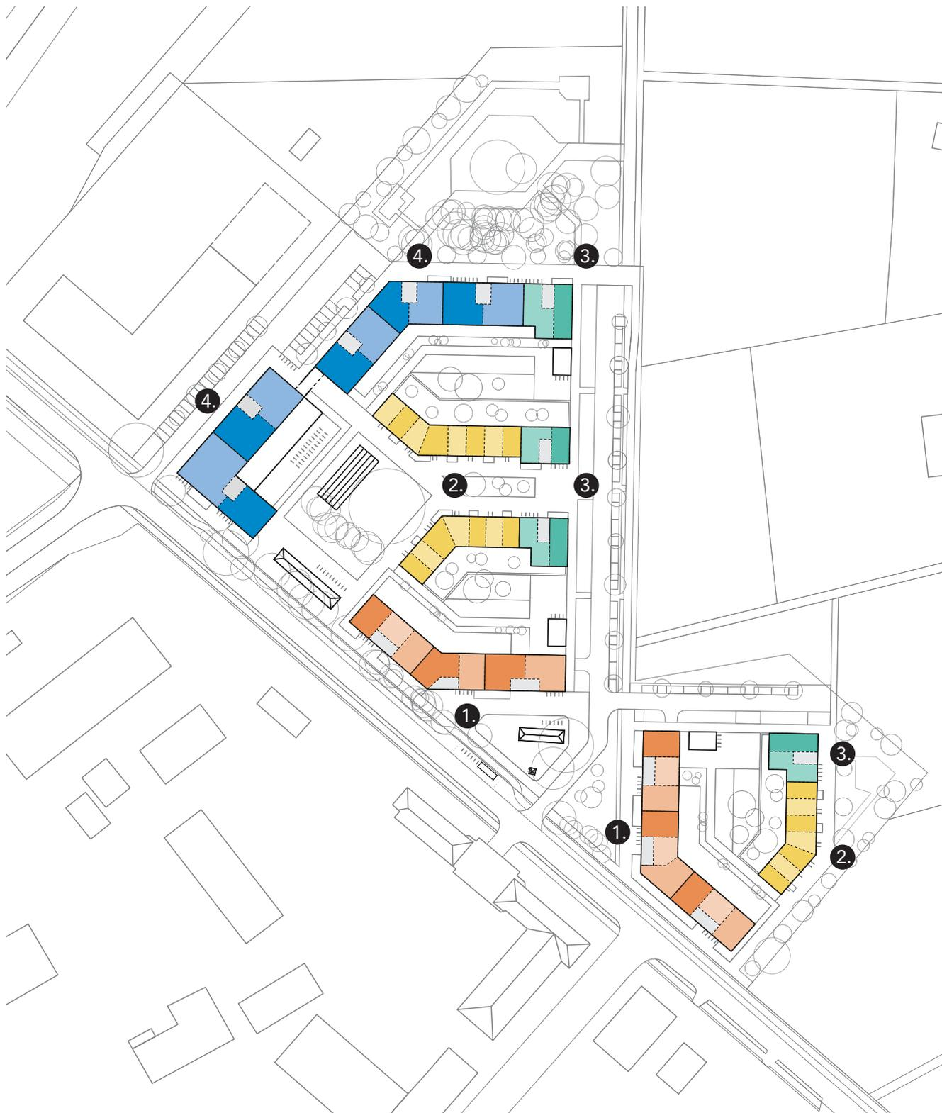
Abb. 24. Lage und Verteilung der einzelnen Typologien mit Kennzeichnung der Erschließungszonen und möglichen Einteilung in Wohn- bzw. Gewerbeeinheiten (Regelgeschoss)
