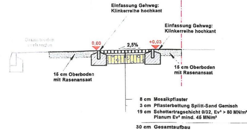
Konstruktionsaufbau nach RStO 01
