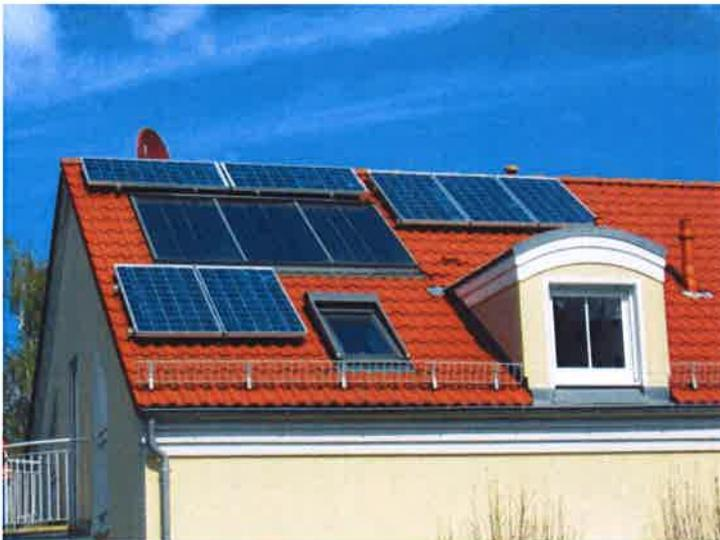
Abbildung 1: 6qm Flachkollektor (Mitte) und PV-Module, Stand Ende 2012
