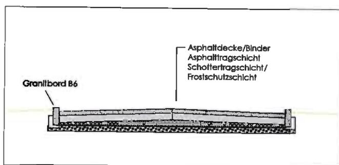
Prinzipskizze: Asphaltaufbau nach RStO
